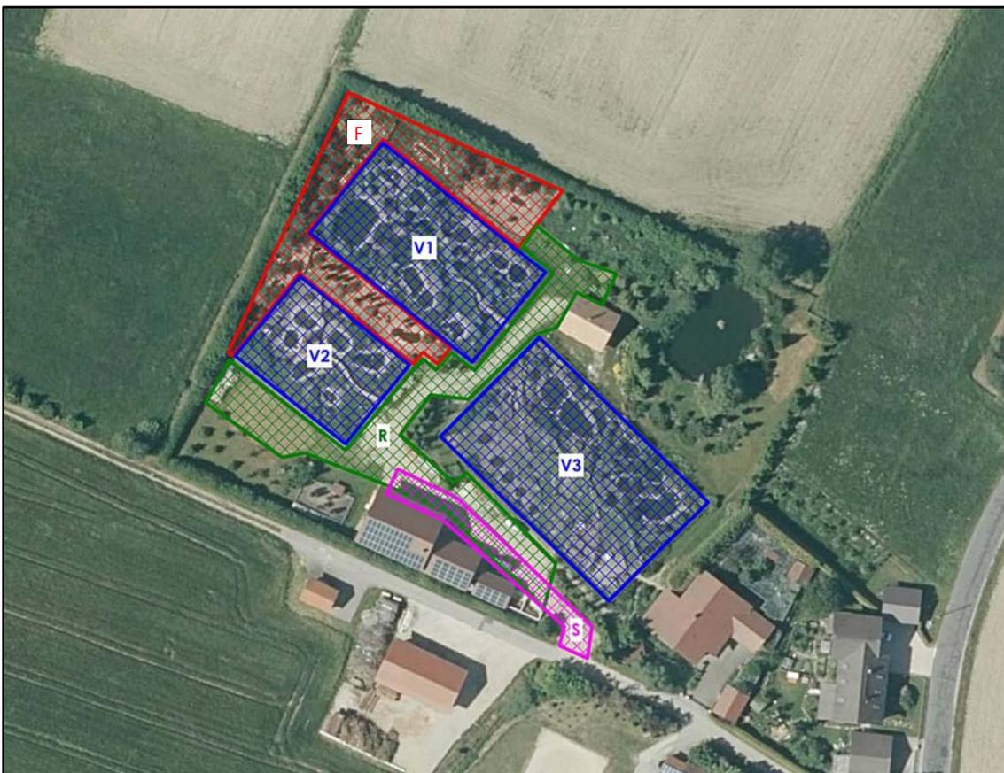
Abbildung 3: Luftbild mit Darstellung der relevanten Schallquellen /9/
