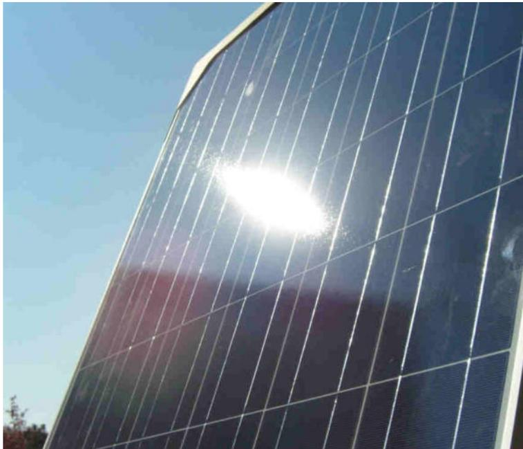
Bündelaufweitung beim Sonnentest eines polykristallinen Moduls,
