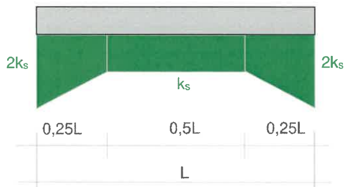
Bild 1: Verteilung des Bettungsmoduls k_s unter der Gründungsplatte
