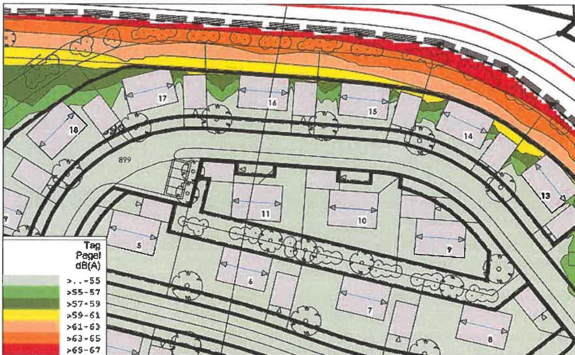
Abbildung 7: Prognostizierte Beurteilungspegel, Tagzeit in 2,0 m über Geländeoberkante
