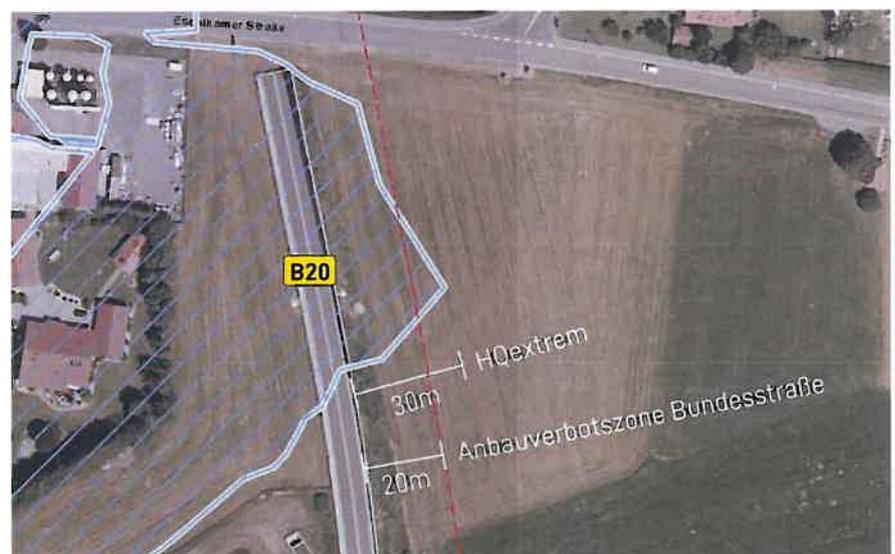
Abbildung 5 / HQextrem, Anbauverbotszone / Quelle: Geo-BIS Cham 3.4 / ohne Maßstab
