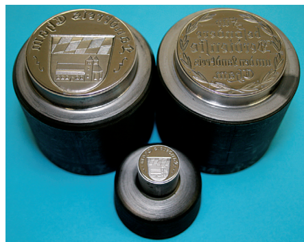
Prägestempel der Kreishrenzeichen Cham (links) und Roding (rechts).
