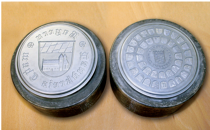
Das mächtige Stempelpaar aus Stahl zur Ausprägung der Großen Amtssiegelmedaille des Landkreises Cham (Foto: Bayerisches Hauptmünzamt)
