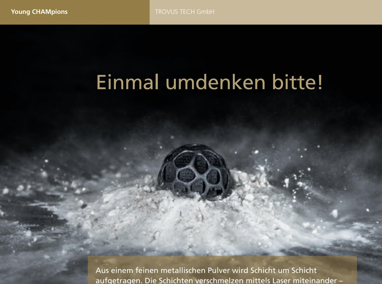
Aus einem feinen metallischen Pulver wird Schicht um Schicht aufgetragen. Die Schichten verschmelzen mittels Laser miteinander – und am Ende entsteht ein fertiges, komplexes Bauteil: Der 3D-Metalldruck revolutioniert die Branche und macht plötzlich Dinge möglich, von denen man lange nur träumen konnte.
