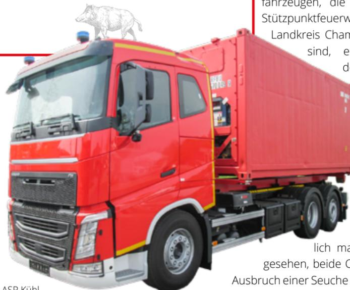
ASP Kühlcontainer auf Wechselladerfahrzeug
