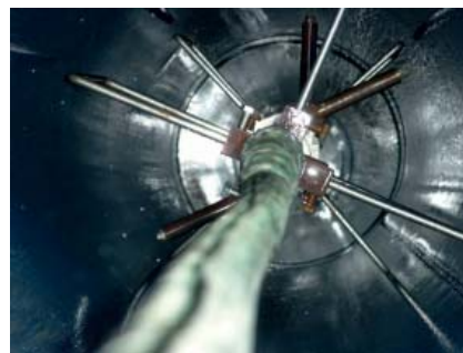
Jet Master (Gerät zur Regenerierung)
