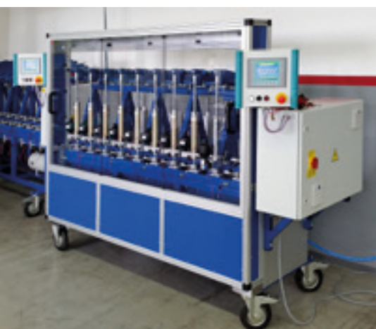
Diese Maschine von Muhr prüft die Hydraulikzylinder von Achterbahnen auf Herz und Nieren.
